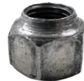
Écrou usé - Ne pas utiliser
